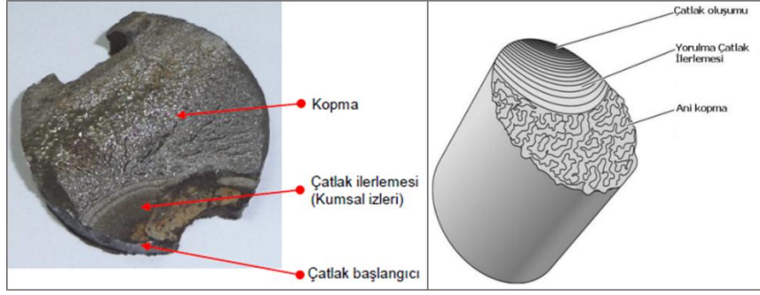
Şekil 9. Yorulma sonucu kırılan bir malzemeye ait kırılma yüzeyi ve yüzeyin şematik gösterimi
