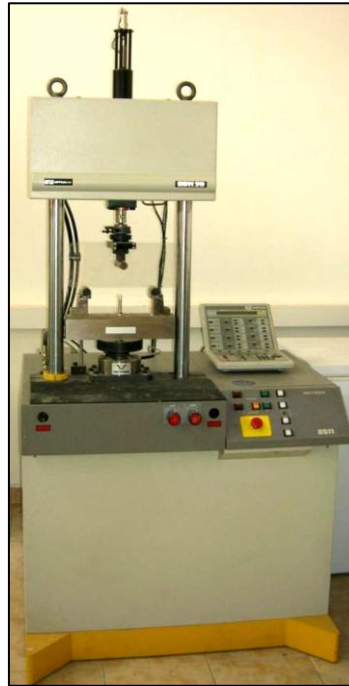
Şekil 16. Intron 8511.20 model servohidrolik yorulma test cihazı
